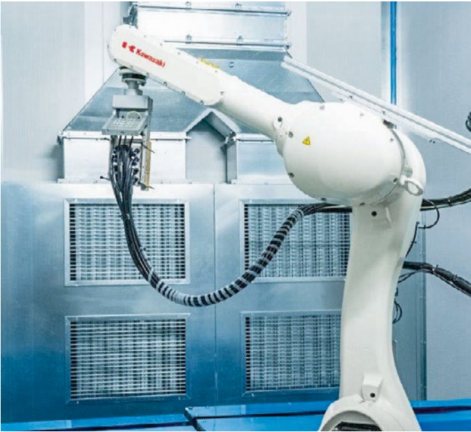
Für die Reinigung und Vorbehandlung der Bauteile ist eine gekapselte und automatisierte CO 2 -Schneestrahlnreinigung implementiert.
